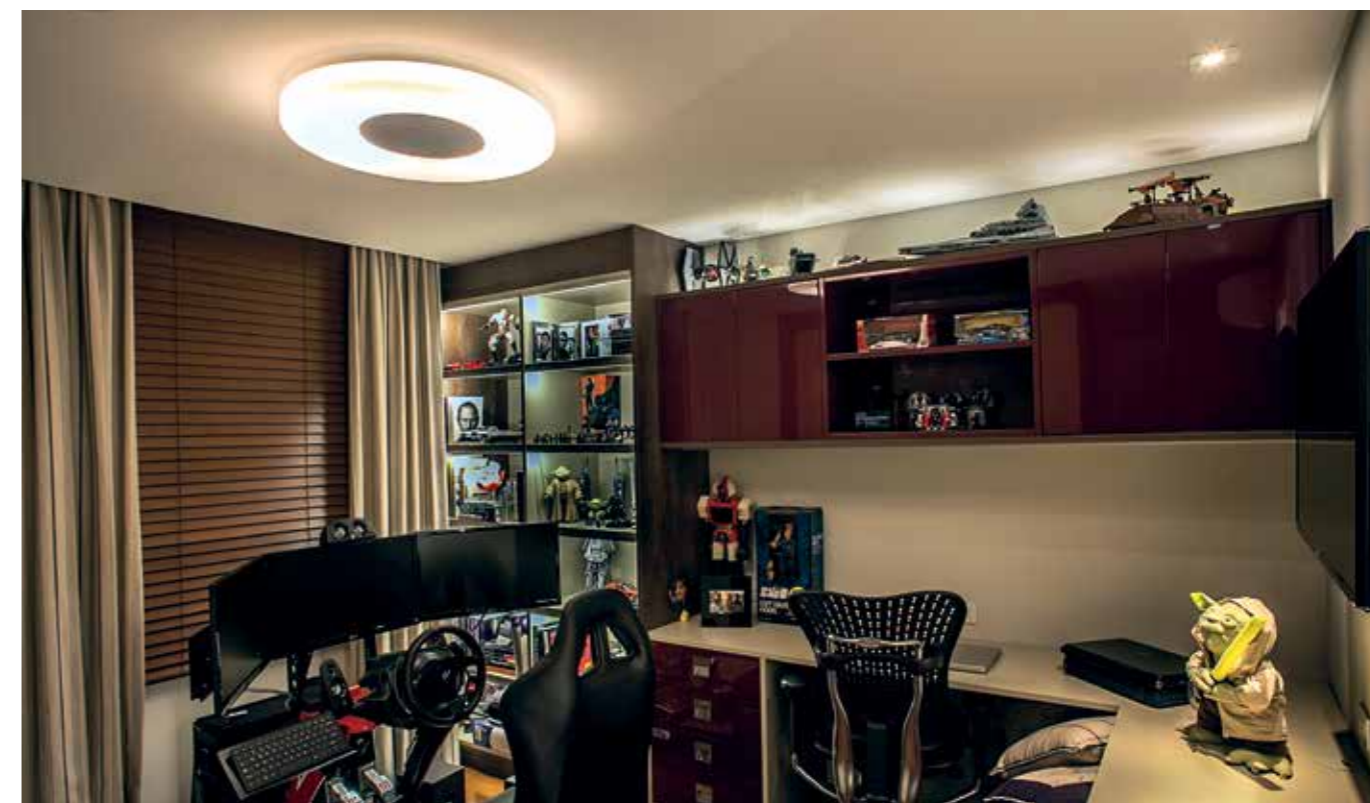
Iluminação do escritório possui sistema automático que varia a temperatura de cor conforme a hora do dia, minimizando possíveis impactos deletérios no organismo causados pela luz artificial.
