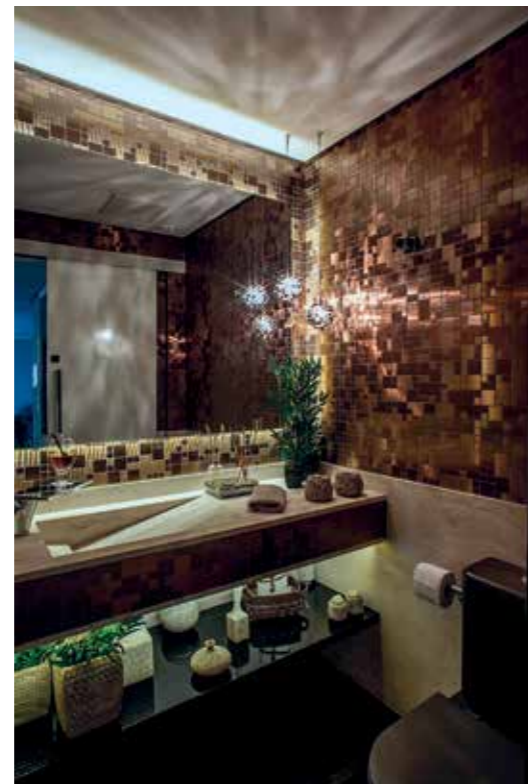
Ao lado, detalhes do efeito céu estrelado com fibras óticas aplicadas atrás das pastilhas de vidro do banheiro do escritório, e do lavabo, com pendentês Swarovski equipados com lâmpada bipino LED de 2,5W cada.
